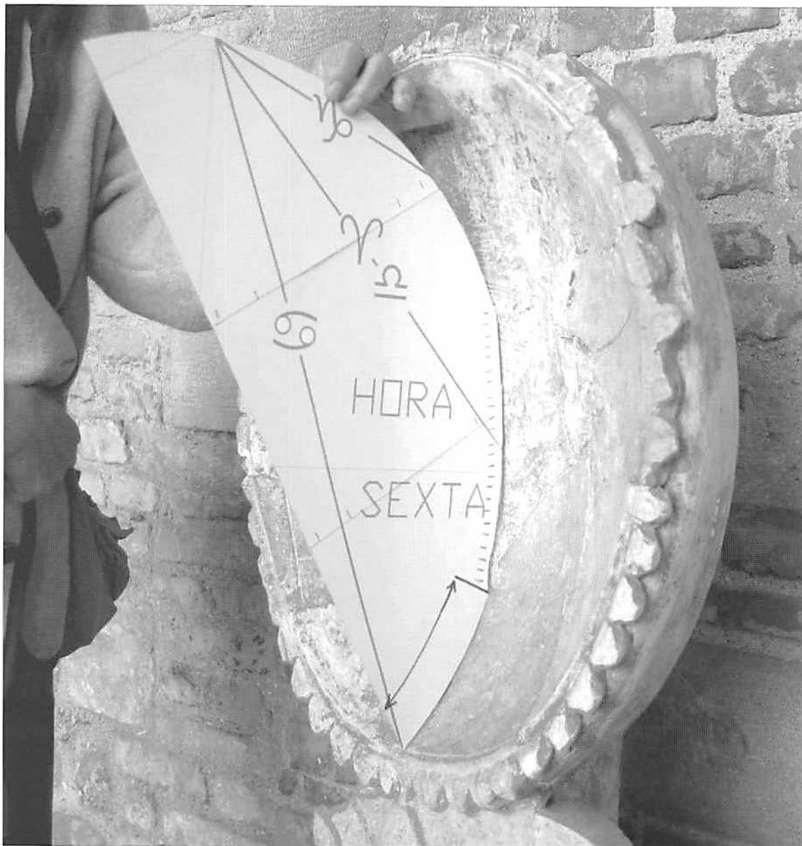
Fig. 6. Sul tratto di cerchio meridiano originale l'aderenza è perfetta. Non altrettanto sul tratto posticcio in gesso; proprio qui si è dovuto ritagliare il cartoncino causa l'ingombro del materiale aggiunto.
