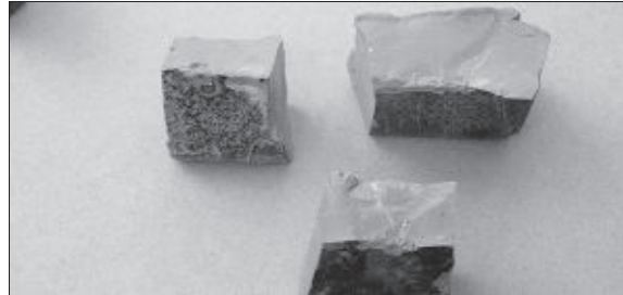
Fig. 5. "Scorzette", tessere di mosaico che presentano uno strato superficiale di colore ed aspetto diverso rispetto alla massa.
