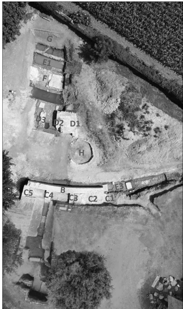
Fig. 2. Rilievo da drone del giardino di palazzo Brunner con le murature portate alla luce nei tre anni di scavo. Vi sono indicati: A. l'ubicazione di uno dei pilastri di facciata; B. il muro ellittico cui si addossavano 5 muri radiali della raggiera esterna (C1-C5); D1-3. muri radiali della raggiera interna; E. il sistema idraulico (E1 e E2: le due canalette ellittiche portate alla luce con lo scavo, E3: il tratto di canaletta radiale; si osservi che esse sono riempite dell'acqua di falda in risalita); F. il podio; G. l'area dell'arena; H. la calcera (rilievo di Agostino Favaro, rielaborazione di Patrizia Basso).
